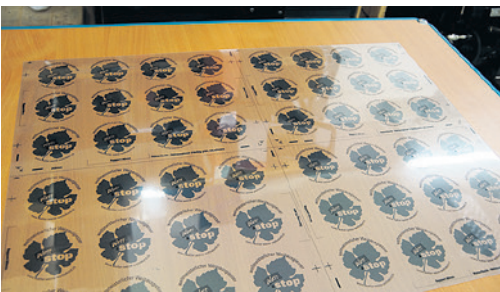
Jede Farbe hat ihren eigenen Film, wo pro Farbe oder Film eine Schablone (Sieb) gibt.
